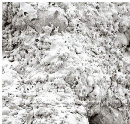
REM-Aufnahmen einer HA-gespritzten Oberfläche
